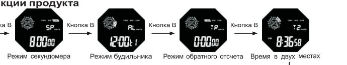
1. В режиме без настройки нажмите кнопку B, чтобы выбрать режим работы. В любом режиме нажмите кнопку A (EL) в течение трех секунд.
